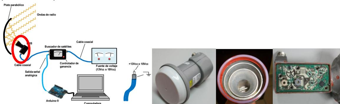
**Figura 4.** El detector o LNB que venía incluido con la antena y su interior.
