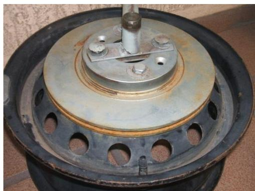
5.-**Fig.39** (en la siguiente imagen vas a poder apreciar el orden de como poner la base del telescopio y la placa de metal). Como por ultimo tienes que atornillar la base de la antena a la placa de meta quedando el balero por debajo.
