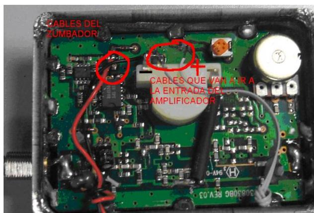
**Figura 11.** Tarjeta del Buscador de satélites, mostrando las conexiones a realizar.
