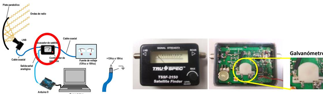
**Figura 5.** El 'finder' o buscador de satélites y su interior, remarcando el galvanómetro.
