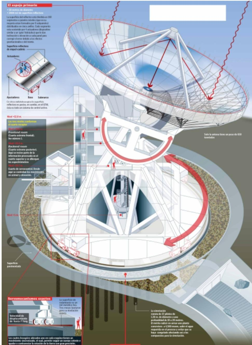
Figura 7. Visualización de algunos detalles y del interior del GTM.
