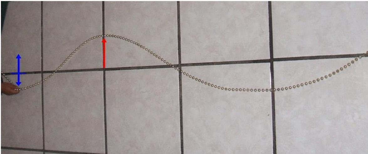
Figura 2. Fotografía instantánea y esquema de una **onda transversal**
